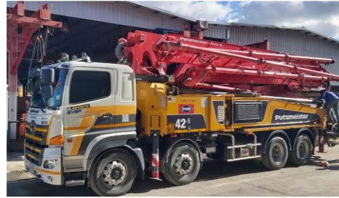
Concrete Pump ปูม 36-42 เมตร
