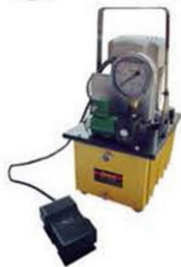
ACT-630S One way valve ใช้งานร่วมกับกระบอกไฮดรอลิค แบบขาเหยียบ single acting cylinder
