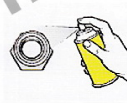
ตรวจสอบรอยร้าวด้วย น้ำยา Developer LD7
