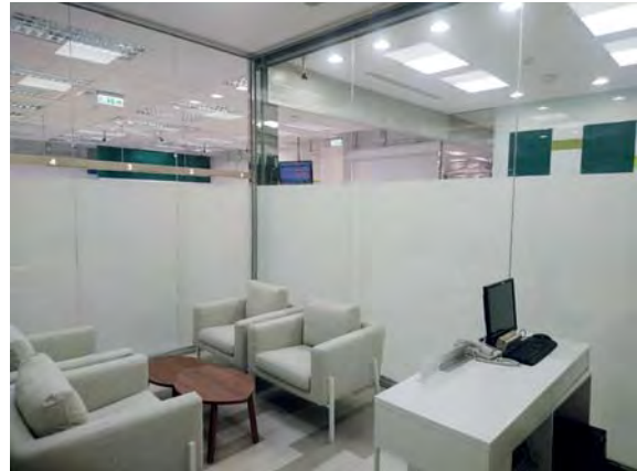
While power off: opaque ขณะไม่จ่ายไฟเข้าฟิล์ม: ฟิล์มทึบแสง
