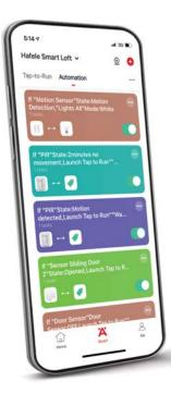
Automations: ระบบการทำงานร่วมกันแบบอัตโนมัติของอุปกรณ์ โดยกำหนดเงื่อนไข Based on events, you can define how to set your devices. An event can be triggered by a sensor, schedule or a device status change. Automation will make your home smarter.
