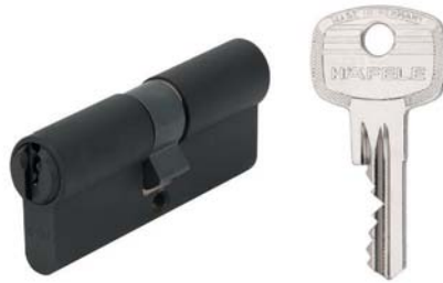
916.08.280* Double profile cylinder ใ้กุญแจสองทาง ทองเหลืองสีดำด้าน ความยาว 31.5/31.5 มม.
