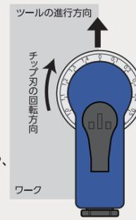
△注意:ワークにあててから始動させると、チップ刃の破損や、反動により手をケガする恐れがあります。
