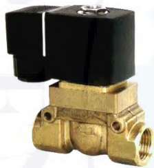
2VT อุณหภูมิ 0-180C , Body Brass ปกติปิด ( NC ) Pressure 0.5-16 Bar
