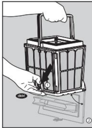
6.1.4 เปิดสลักเพื่อ ปล่อยฝาด้านล่าง เพื่อขจัดสิ่งสกปรก
