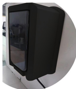
3. ตรวจสอบว่าชุดควบคุมยึดกับผนังอย่างมั่นคง
