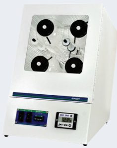
เครื่องจำลองการย่อยได้ โดยวิธี In-vitro Digestibility วิเคราะห์ได้ 100 ตัวอย่าง/ครั้ง ช่วงตัวอย่าง 0.25 - 1 กรัม ใช้เทคนิค Filter bag
