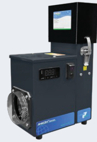
เครื่องอบลมร้อน (RD Dryer) อบตัวอย่างหลังการ Hydrolysis อบได้สูงสุด 20 ตัวอย่าง/ครั้ง ขนาดเล็กประหยัดพื้นที่ มีชุดดักจับไอน้ำ
