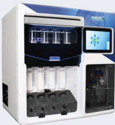
เครื่องจำลองการย่อยได้ โดยวิธี In-vitro Digestibility วิเคราะห์ได้ 100 ตัวอย่าง/ครั้ง ช่วงตัวอย่าง 0.25 - 1 กรัม ใช้เทคนิค Filter bag
