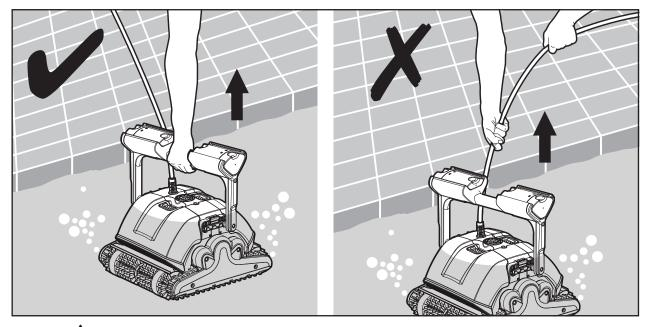
DO NOT PULL THE POOL CLEANER FROM THE POOL USING THE CABLE.
