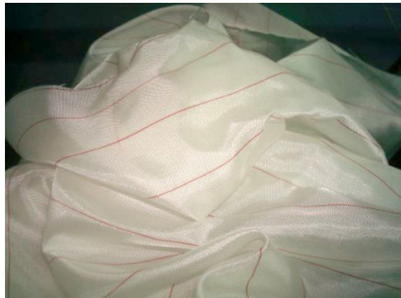
รายการที่ 3 Peelply ใช้ปูกับใยแก้วเป็นชั้นกันไม่ให้ Vacuum Bag, ท่อ, และอุปกรณ์อื่นๆ ติด กับชิ้นงานเมื่อแห้งแล้ว มีคุณสมบัติยอมให้เรซินไหลผ่านได้ แต่จะไม่ติดกับเรซิน
