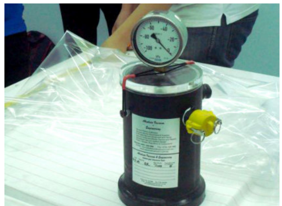
รายการที่ 11 ถังดักเรซิน เป็นถังที่ต่อจันทันกลางระหว่างปั๊มกับโมลด์ เรซินที่ล้นออกจากโมลด์จะไหลไปตามท่อซิลิโคนแล้วล้นเข้าไปในถังดักแทนที่จะเข้าไปถึงตัวปั๊มโดยตรง
