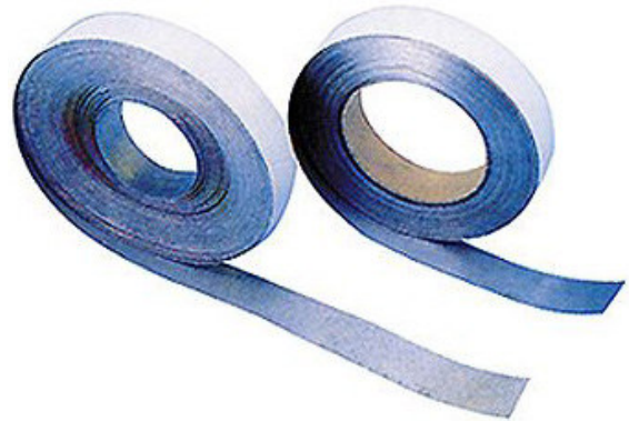
รายการที่ 2 Sticky Tape เหมือนเทปกาวยี่ห้อมาแต่คุณภาพดีกว่า ใช้ซึบ Vacuum Bag รอบโมลด์ให้คงความเป็นสุญญากาศไว้
