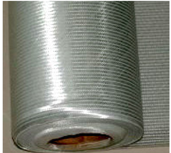
รายการที่ 10 ใยทางเดียว (Uni-direction) หรือสองทาง (Biaxial) เพื่อเพิ่มความแข็งแรงตามแต่ที่ออกแบบ
