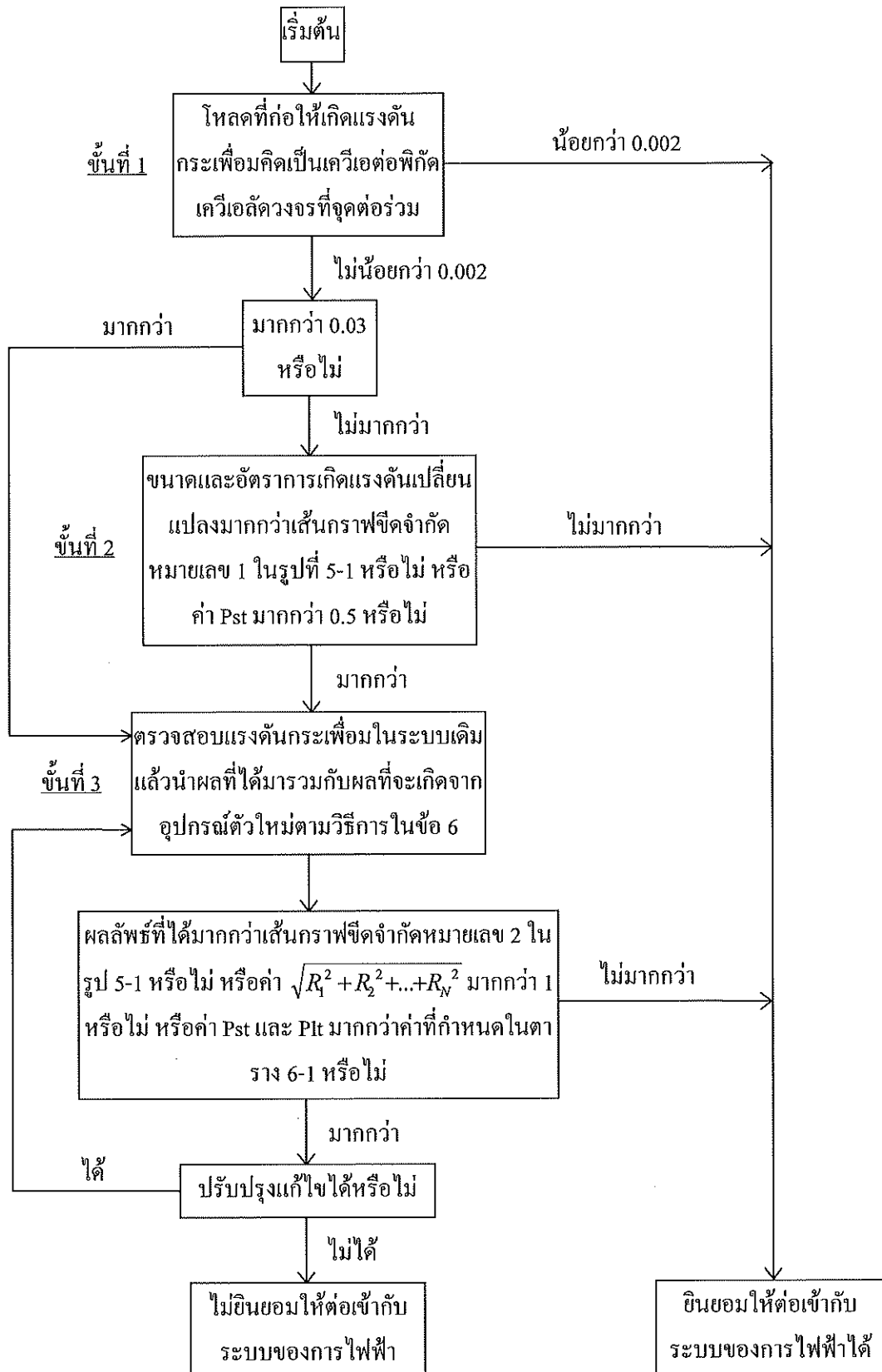
รูปที่ ผ-1 แผนผังลำดับขั้นตอนการตรวจสอบโหลดที่ก่อให้เกิดแรงดันกระแสเพื่อ
