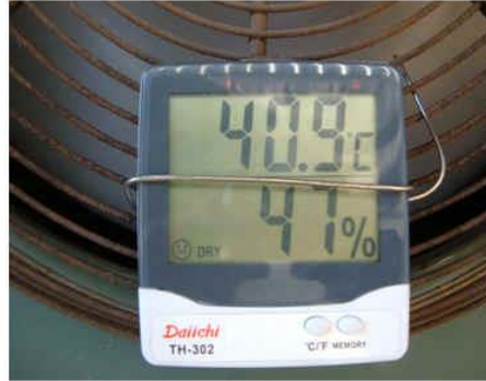
รูปที่ 6.15-15 อุณหภูมิอากาศที่ออกจาก Condenser ลดลงเป็น 40.9 °C ความชื้นที่ 47 %
