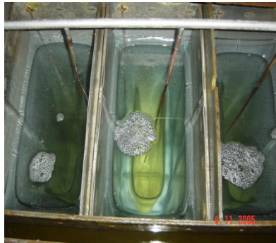
รูปที่ 6.9-1 การผลิตน้ำแข็งซองและภาพตัดขวางแสดงลักษณะของซองน้ำแข็งในบ่อน้ำเกลือ
