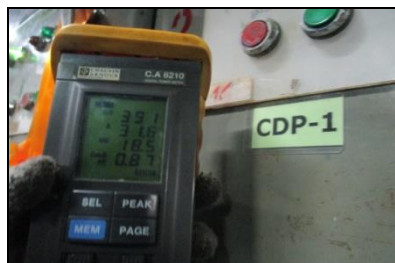
รูปที่ 5.11-36 อัตราการไหลและกำลังไฟฟ้า CDP-01 ก่อนปรับปรุง
