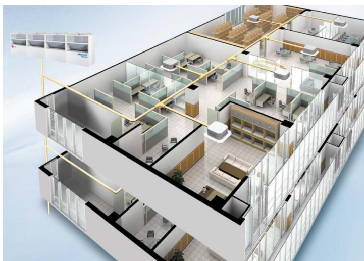
รูปที่ 5.12-17 ตัวอย่างระบบ VRV (Variable refrigerant volume)
