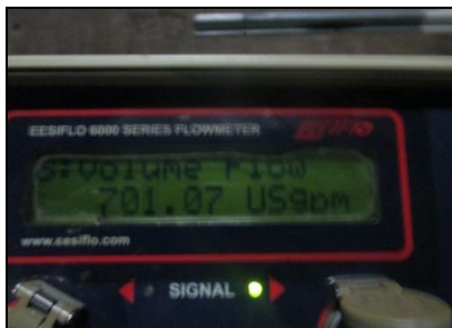
รูปที่ 5.11-37 อัตราการไหลและกำลังไฟฟ้า CDP-01 หลังปรับปรุง
