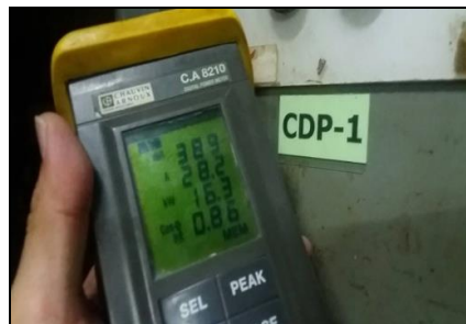
รูปที่ 5.11-37 อัตราการไหลและกำลังไฟฟ้า CDP-01 หลังปรับปรุง
