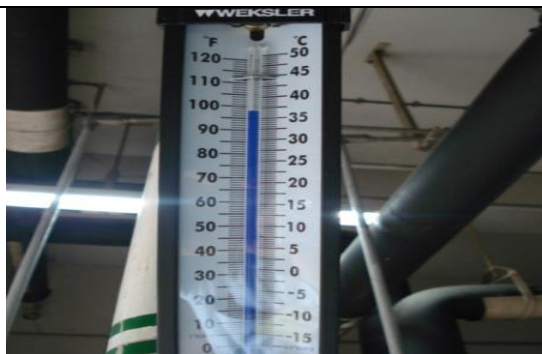
รูปที่ 5.11-30 อุณหภูมิน้ำหล่อเย็นก่อนเข้าเครื่องทำน้ำเย็น (ก่อนปรับปรุง)
