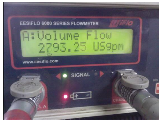
รูปที่ 5.11-12 ปรับวาล์วน้ำระบายความร้อนที่ header บริเวณหอระบายความร้อน
