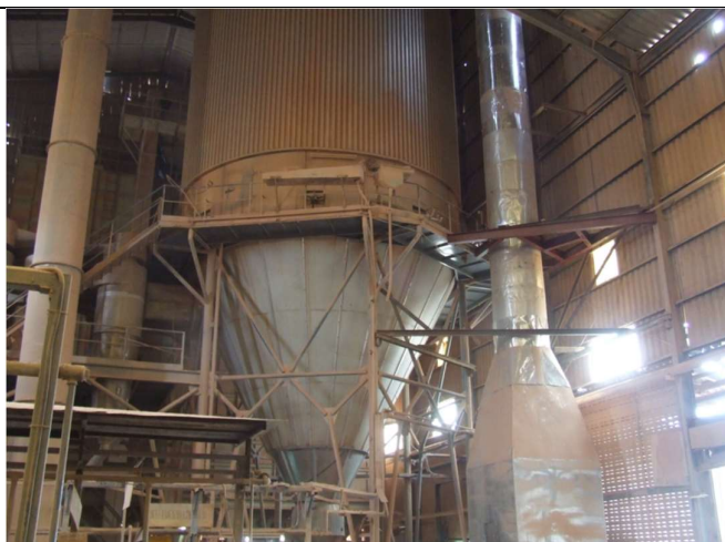
รูปที่ 4.8-1 สภาพก่อนปรับปรุงใช้อากาศที่อุณหภูมิปกติเข้าเผาไหม้ใน Spray Dryer
