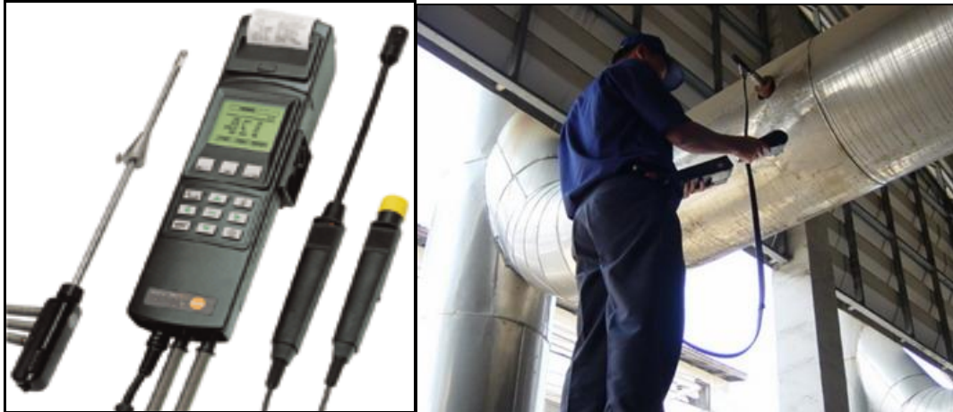
รูปที่ 3.8-5 แสดงเครื่องมือวัดการเผาไหม้และการใช้งาน
