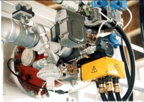
รูปที่ 3.9-7 ขยายรูปหัวเผาเริเจนเนอเรทีฟที่ติดกับเตาเผา (4)
