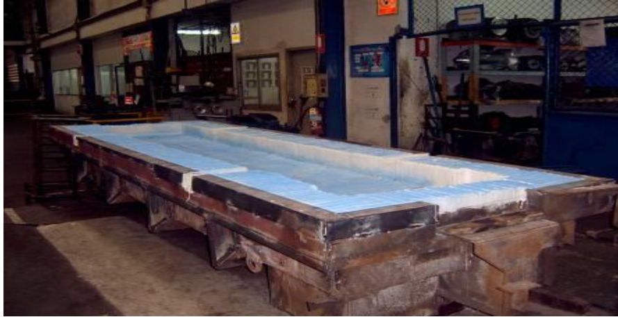
รูปที่ 3.8-2 แสดงช่องเปิดเตาเผาปลายกันโคลงหลังปรับปรุง
