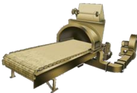
รูปที่ 2.3-4 แสดงลักษณะเตาเผาเชื้อเพลิงระบบสโตเกอร์แบบกระจาย
