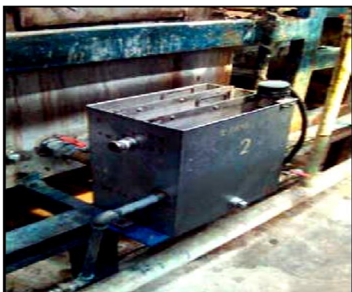
รูปที่ 2.12-17 ถังพักน้ำร้อนและเครื่องสูบน้ำกลับจากบ่อที่ 7 ไปยังบ่อที่ 5
