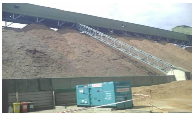
รูปที่ 2.12-4 เชื้อเพลิงที่ป้อนให้กับหม้อไอน้ำเพื่อใช้ในการผลิตไฟฟ้า
