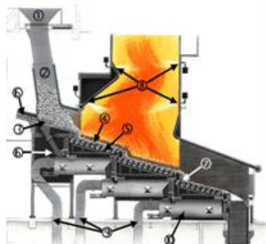
รูปที่ 2.3-4 แสดงลักษณะเตาเผาเชื้อเพลิงระบบสโตเกอร์แบบกระจาย
