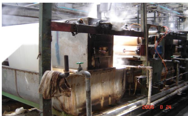
รูปที่ 2.12-15 เครื่อง L-Box (กระบวนการซักผ้าขาว)
