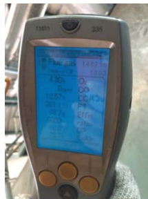
รูปที่ 2.12-12 การตรวจวัดประสิทธิภาพการเผาไหม้หลังปรับปรุง
