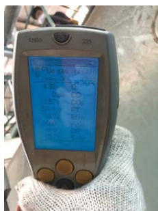
รูปที่ 2.12-10 การตรวจวัดประสิทธิภาพการเผาไหม้ก่อนการปรับปรุง
