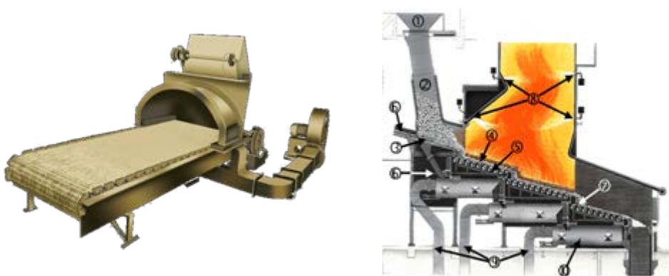
รูปที่ 2.3-4 แสดงลักษณะเตาเผาเชื้อเพลิงระบบสโตกเกอร์แบบกระจาย
