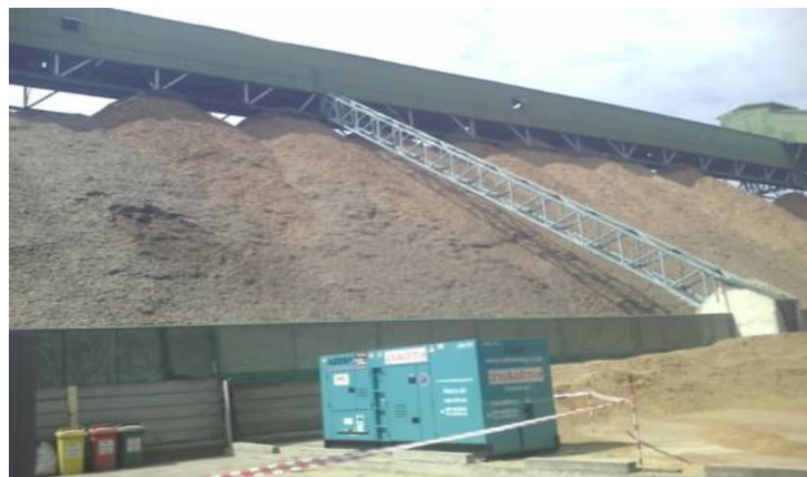
รูปที่ 2.12-4 เชื้อเพลิงที่ป้อนให้กับหม้อไอน้ำเพื่อใช้ในการผลิตไฟฟ้า
