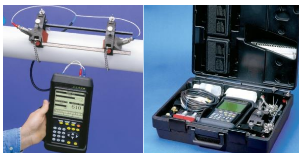
รูปที่ 1.5-6 การวัดอัตราการไหลแบบอัลตราโซนิก
