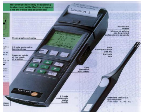
รูปที่ 1.3-2 เครื่องมือวัดความชื้นสัมพัทธ์แบบอิเล็กทรอนิกส์
