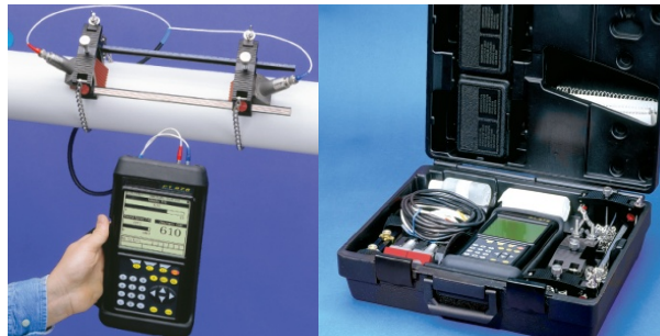
รูปที่ 1.5-6 การวัดอัตราการไหลแบบอัลตราโซนิก
