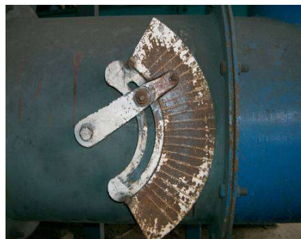
รูปที่ 7.12-4 ใบพัดของพัดลมเป่าทรายชุดใหม่และการปรับแอมเปอร์พัดลมใหม่ (เปิดให้มากขึ้น)
