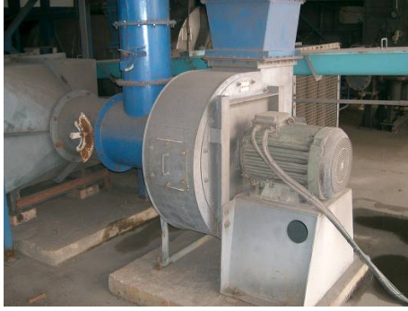
รูปที่ 7.12-3 พัดลมเป่าทรายและการปรับหรีดแอมเปอร์ ก่อนลดขนาดใบพัด
