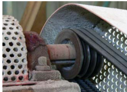
รูปที่ 7.12-2 แสดงการหรี Damper และ Pulley เดิมของพัดลมเครื่องบด Jacobson
