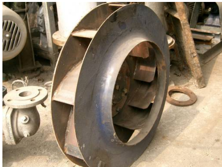
รูปที่ 7.12-4 ใบพัดของพัดลมเป่าทรายชุดใหม่และการปรับแอมเปอร์พัดลมใหม่ (เปิดให้มากขึ้น)
