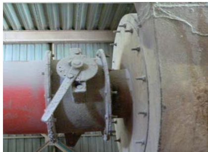
รูปที่ 7.12-2 แสดงการหรี Damper และ Pulley เดิมของพัดลมเครื่องบด Jacobson
