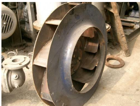
รูปที่ 6-29 ใบพัดของพัดลมเป่าทรายอันใหม่ และการปรับรีดแมเปอร์พัดลมใหม่ (หรือให้น้อยลง)
