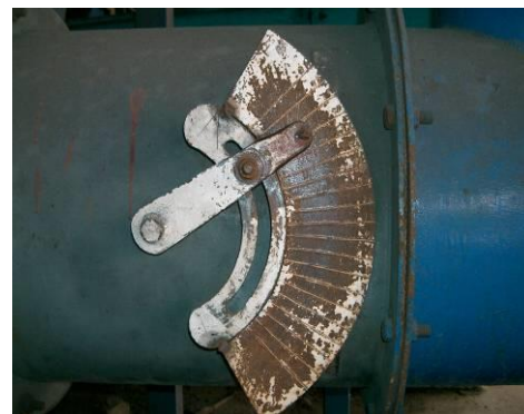
รูปที่ 6-29 ใบพัดของพัดลมเป่าทรายอันใหม่ และการปรับรีดแมเปอร์พัดลมใหม่ (หรือให้น้อยลง)
