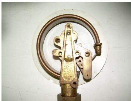
รูปที่ 6.6-2 เครื่องมือวัดความดันแบบท่อบูรตอง
