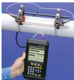
รูปที่ 6.6-3 เครื่องมือวัดอัตราการไหลแบบอัลตราโซนิก
