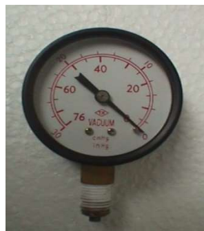
รูปที่ 6.6-2 เครื่องมือวัดความดันแบบท่อบูรตอง
