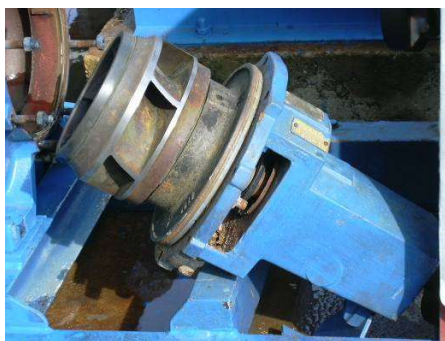
รูปที่ 6.12-12 แสดงใบพัดเครื่องสูบน้ำขนาด 18.5 ซม หลังปรับปรุง
