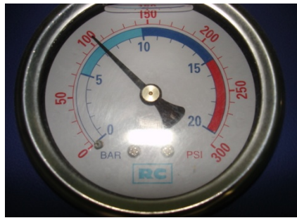
รูปที่ 5.10-7 การตั้งความดันในการผลิตอากาศอัดหลังปรับปรุง
