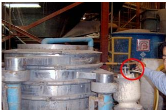
รูปที่ 5.10-11 รูรั่วบริเวณข้อต่อ เข้าเครื่องสั่น (Shake) ของหน่วยงานเตรียมผสมน้ำดิน
