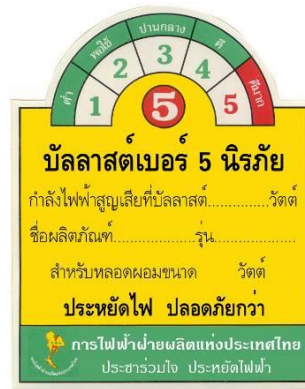
รูปที่ 3-17 ตัวอย่างฉลากบัลลัสต์กำลังสูญเสียต่ำ หรือ “บัลลัสต์เบอร์ 5 นิรภัย” ที่มีค่ากำลังไฟฟ้าสูญเสียในตัวบัลลัสต์ต่ำกว่า 6 W ใช้สำหรับสำหรับหลอดฟลูออโรซีนขนาด 18 W หรือ 36 W
