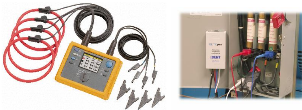
รูปที่ 3.36 เครื่องวัดและบันทึกค่าทางไฟฟ้าแบบต่อเนื่อง
