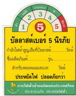
รูปที่ 3.6-1 ตัวอย่างฉลากบัลลาสต์กำลังสูญเสียต่ำ หรือ “บัลลาสต์เบอร์ 5 นีรภัย”
