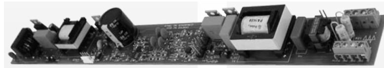
รูปที่ 3.6-3 ตัวอย่างภาพอุปกรณ์ภายในกล่องบัลลาสต์อิเล็กทรอนิกส์
