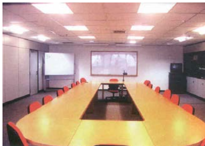
รูปที่ 3.6-11 ลักษณะการกระจายแสงสว่างของดวงโคมแบบกระจายแสงสว่างลงด้านล่าง (Direct Luminaire)
