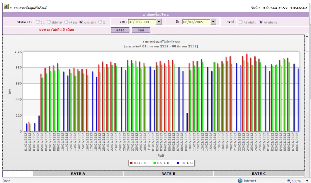
รูปที่ 2.6-5 ความต้องการพลังไฟฟ้าสูงสุดผ่านระบบ AMR ของผู้ใช้ไฟฟ้ารายหนึ่ง
