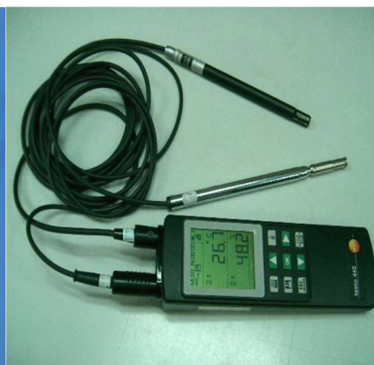
ง) วัดอุณหภูมิและความชื้นอากาศ
