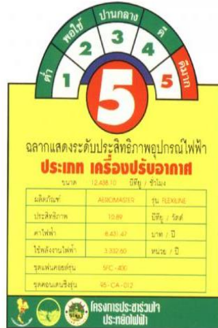
รูปที่ 5-8 : No.5 efficiency label in air conditioning unit (EGAT,2012)
