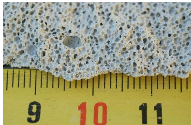
รูปที่ 5-6 : Cross sectional of AAC concrete (Greenbang,2012)
