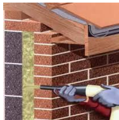
รูปที่ 5-13 : PU foam in cavity wall insulation (Dino Green,2012)
