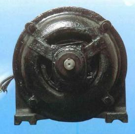
1916 โครงสร้างของมอเตอร์มีขนาดเล็กลง ขณะเดียวกัน Cooling Fan ก็ได้ติดตั้งใน มอเตอร์ด้วย
