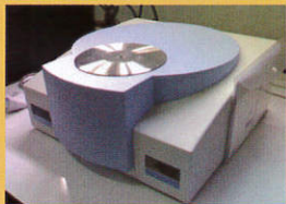
การทดสอบเสถียรภาพ ทางความร้อน Thermal Stability : OIT
