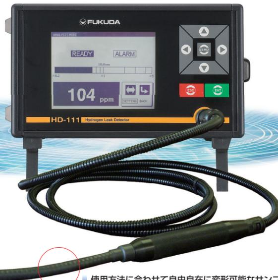
プローブ先端の水素センサで、漏れを検出します。先端はネジ付き (M5 双) になっており、継手を使用して治具と接続するなど汎用性の高い作りになっています。
