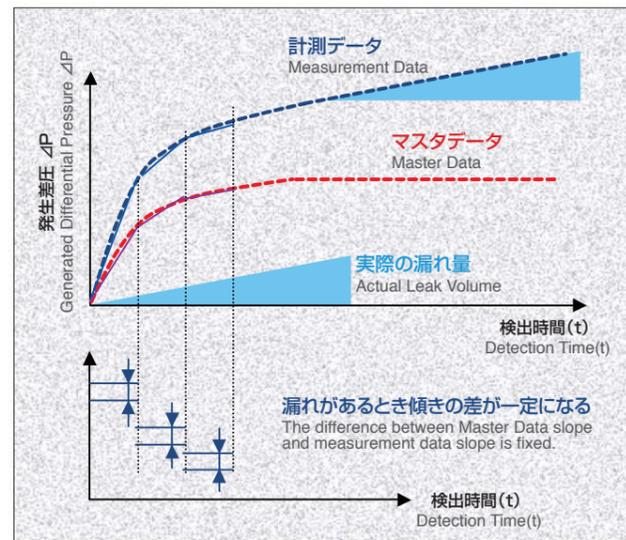
漏れによる差圧値は、一般に時間経過に比例した傾きで増加します。これに対して圧縮熱影響や変形要素は、時間経過と共に収束する特性を持っています。この性質を利用し差圧値全体から漏れによる直線成分を差し引くことにより漏れ以外の要素（測定環境下での変動要素）=マスタデータを求め保存します。計測差圧データとマスタデータの一定区間ごとの傾きの差を求めることにより漏れ量を算出します。データ処理により、通常の計測時間より短い時間で良否判定を行います。
