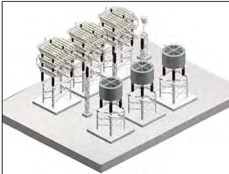
《110kV 3P 50Hz 50Mvar Open-rack Capacitor Bank》
