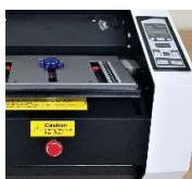
หน้าจอแสดงจำนวนกระดาษที่พับ สามารถตั้งค่าพับล่วงหน้า
