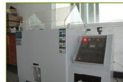
Salt spray test machine precision: ทดสอบการทนสภาพอากาศ
