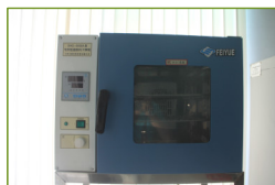
Constant temperature oven: ทดสอบการทนต่อความร้อนที่ 200°C
