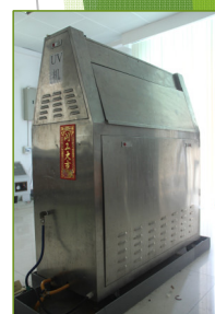
UV test machine: ทดสอบการทนต่อแสง UV
