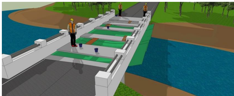
รูปที่ 5.5.1-1 ตัวอย่างการติดตั้งและวัสดุของตาข่ายเชฟตี้
