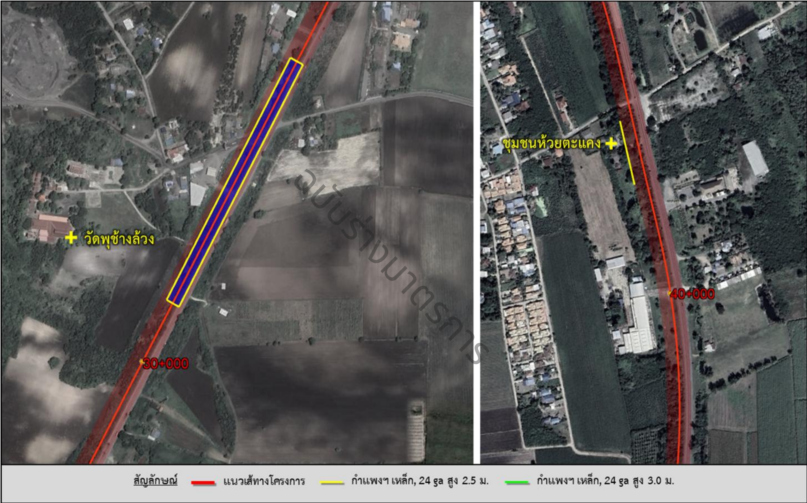
รูปที่ 5.5.2-1 ตำแหน่งติดตั้งกำแพงกันเสียงชั่วคราวในระยะก่อสร้าง
