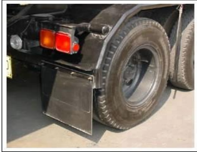
รูปที่ 5.2.4-3 ตัวอย่างการติดตั้งแผ่นกันฝุ่นที่ล้อรถบรรทุก
