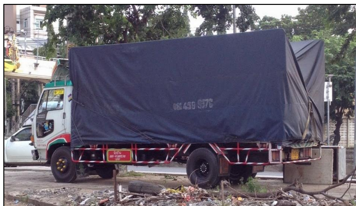
รูปที่ 5.2.4-2 ตัวอย่างการใช้ผ้าใบปิดคลุมวัสดุก่อสร้างขณะขนส่ง
