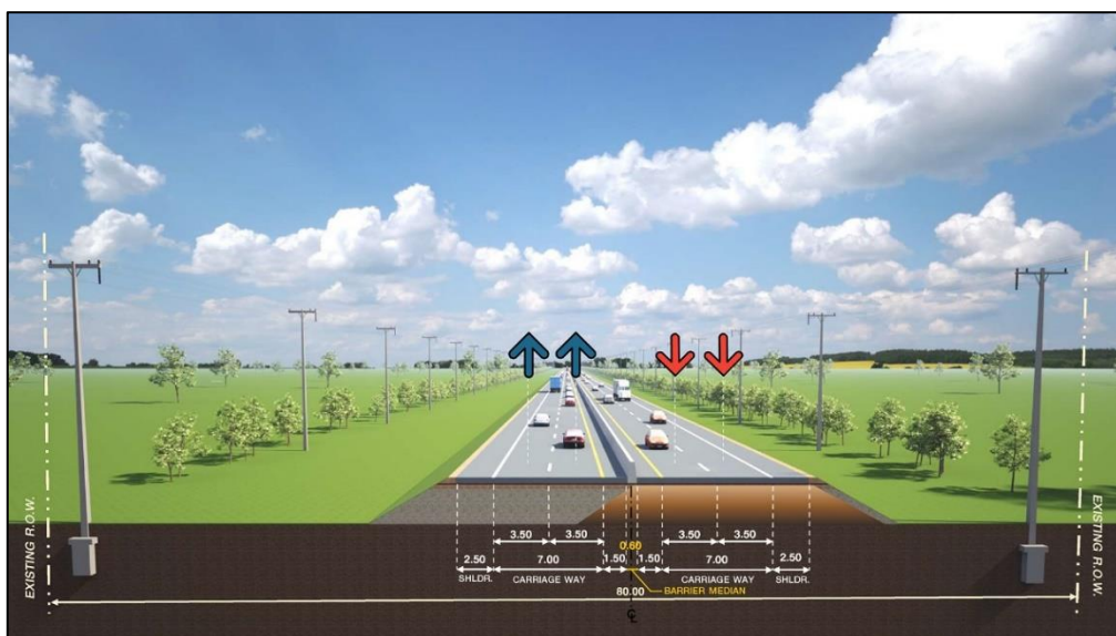
รูปที่ 5-3 รูปแบบที่ 3 เกาะกลางแบบราวกันหรือกำแพง (Barrier Median)
