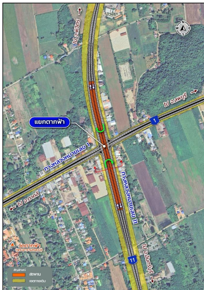
รูปที่ 5-7 รูปแบบที่ 1 สะพานข้ามทางแยกตามแนวทางหลวงหมายเลข 11 และสัญญาณไฟจราจรทางแยกระดับพื้น
