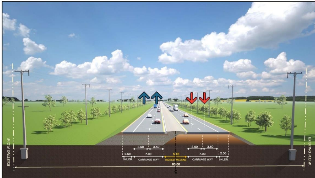
รูปที่ 5-2 รูปแบบที่ 2 เกาะกลางแบบยก (Raised Median)
