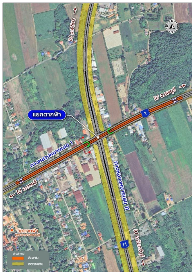
รูปที่ 5-9 รูปแบบที่ 2 สะพานข้ามทางแยกตามแนวทางหลวงหมายเลข 1 และสัญญาณไฟจราจรทางแยกระดับพื้น
