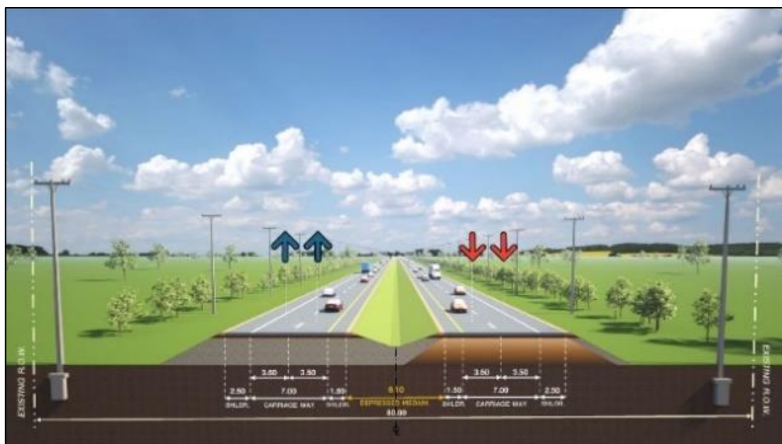
รูปที่ 5-5 เกาะกลางแบบกดเป็นร่อง (Depressed Median) สำหรับพื้นที่นอกเขตชุมชน
