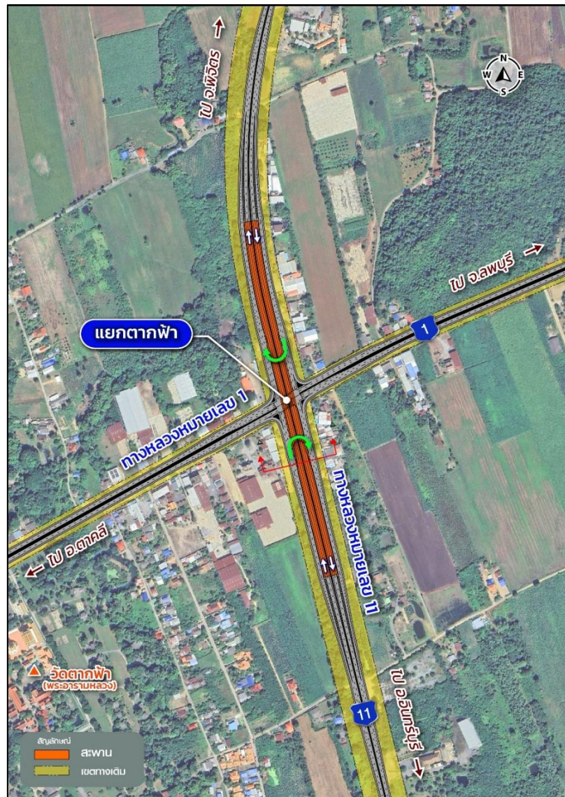
รูปที่ 5-13 สะพานข้ามทางแยกตามแนวทางหลวงหมายเลข 11 และสัญญาณไฟจราจรทางแยกระดับพื้น
