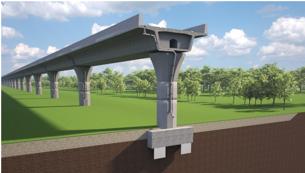
รูปที่ 5-35 ระบบระบายน้ำบนสะพาน
