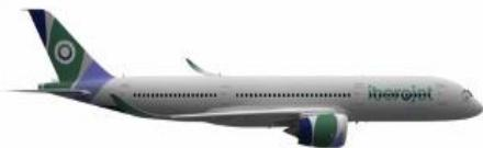
เครื่องบินรุ่นนี้ขับเคลื่อนด้วยเครื่องยนต์ Rolls-Royce Trent XWB-84 ในสายการบินมีจำนวน 2 ลำ สามารถรองรับผู้โดยสารได้ 432 คน
