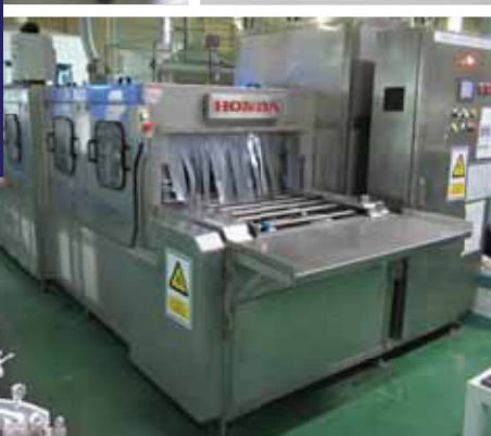
เครื่องล้างทำความสะอาดชิ้นงานแบบ Continue เป็นรูปแบบการล้างที่ใช้คนสองคน หยิบชิ้นงานเข้า-ออกสองด้าน แบบต่อเนื่อง
