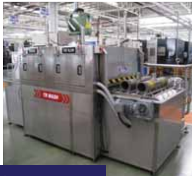
เครื่องล้างทำความสะอาดชิ้นงานแบบ Continue เป็นรูปแบบการล้างที่ใช้คนสองคน หยิบชิ้นงานเข้า-ออกสองด้าน แบบต่อเนื่อง
