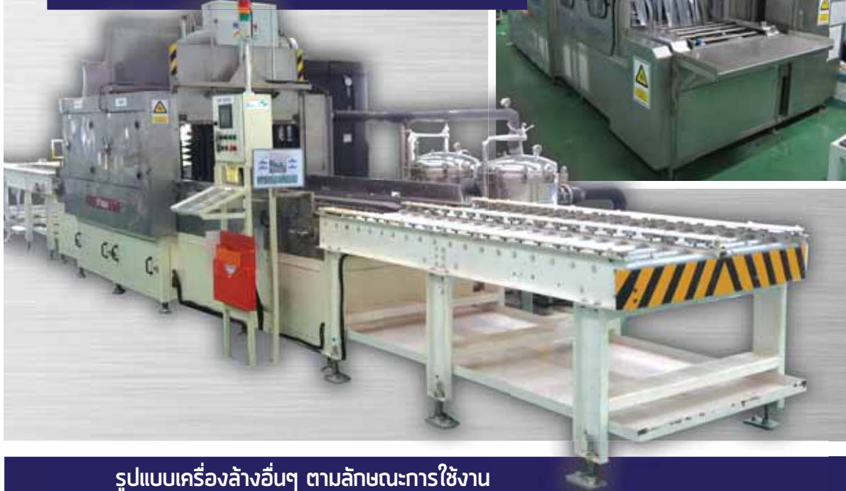
เครื่องล้างทำความสะอาดชิ้นงานแบบ Continue เป็นรูปแบบการล้างที่ใช้คนสองคน หยิบชิ้นงานเข้า-ออกสองด้าน แบบต่อเนื่อง
