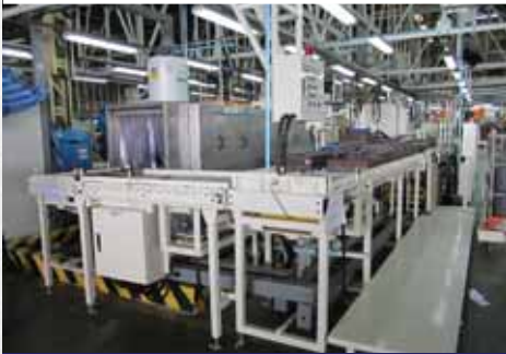
เครื่องล้างทำความสะอาดชิ้นงานแบบ Continue เป็นรูปแบบการล้างที่ใช้คนสองคน หยิบชิ้นงานเข้า-ออกสองด้าน แบบต่อเนื่อง
