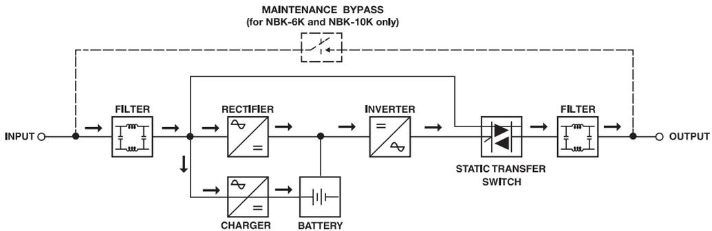
วงจร Rectifier ของ UPS จะทำหน้าที่แปลงไฟฟ้าขาเข้าให้เป็นไฟฟ้ากระแสตรง (DC) และวงจร Charger จะนำไฟฟ้าส่วนหนึ่งประจุแบตเตอรี่เพื่อเก็บไว้เป็นพลังงานสำรอง และไฟฟ้าอีกส่วนหนึ่งเข้าสู่วงจร Inverter เพื่อแปลงเป็นไฟฟ้ากระแสสลับที่บริสุทธิ์คงที่ และจ่ายให้กับอุปกรณ์ไฟฟ้าที่ต่อใช้งานกับ UPS ต่อไป
