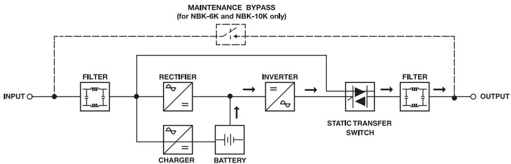
UPS จะทำงานในโหมดจ่ายไฟฟ้าสำรอง (Battery mode) เมื่อเครื่องตรวจสอบพบว่ามีสิ่งผิดปกติเกิดขึ้น เช่น ไฟดับ, ไฟตก, ไฟเกิน, ไฟกระชาก, ความถี่ผิดปกติ ซึ่งเป็นสภาวะทางไฟฟ้าที่เป็นอันตรายต่ออุปกรณ์ไฟฟ้าที่ต่อใช้งานอยู่ โดยเครื่องจะเข้าสู่โหมดจ่ายไฟฟ้าสำรองทันที ไฟฟ้ากระแสตรงจากแบตเตอรี่จะผ่านวงจร Inverter เพื่อแปลงเป็นไฟฟ้ากระแสสลับ และจ่ายให้กับอุปกรณ์ไฟฟ้าที่ต่อใช้งานต่อไป
