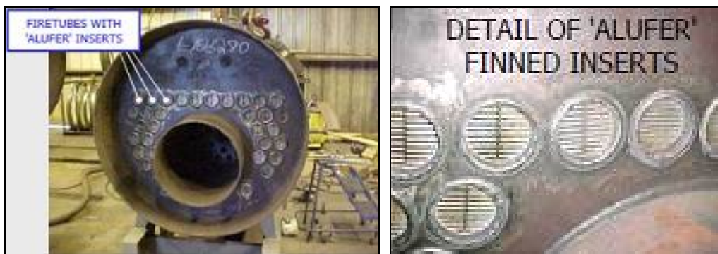
รูปที่ 2-23 ลักษณะของท่อไฟที่ได้ทำการออกแบบมาใหม่
