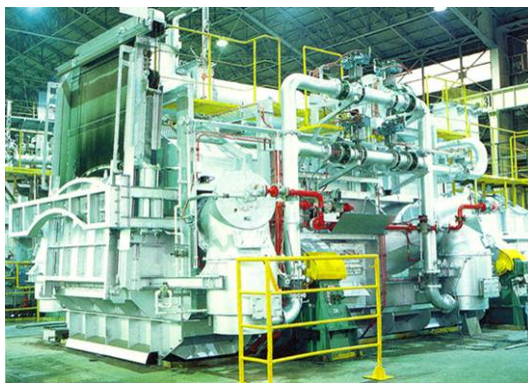
รูปที่ 4-18 หม้อน้ำที่ใช้ระบบ Regenerative combustion system
